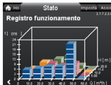
Fig. 36 Esempio di "Registro funzionamento"
