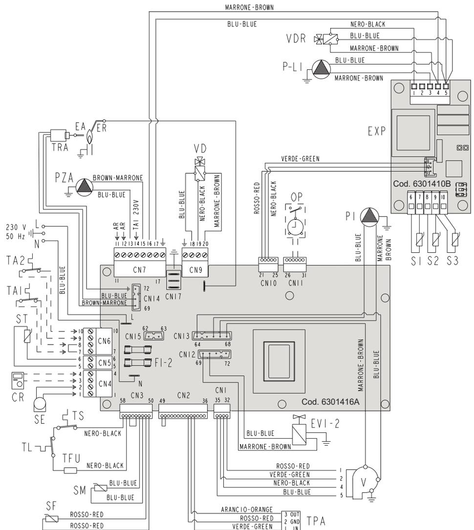
**NOTA:** Collegare il TA1 ai morsetti 7-8 dopo aver tolto il ponte. La sonda collettore solare (S1) è montata in caldaia per esigenze di collaudo interne. Posizionare la sonda nel collettore solare e collegarla elettricamente alla caldaia come indicato dallo schema elettrico.
